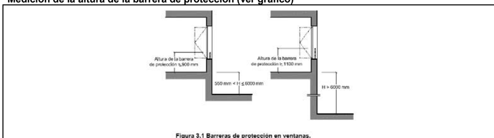
Figura 3.1 Barreras de protección en ventanas.
