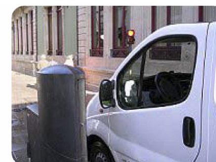
Entrada a una supermanzana por un sistema de bolardos retráctiles
